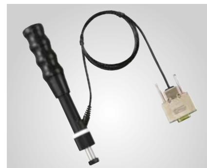
HLDL udarna naprava UD-414 Uporaba za zobnike, varjene vogale itd.
