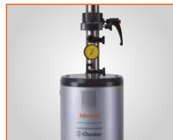
Umerjanje s pomočjo kompleta pripomočkov analogne testne merilne ure (vodoravni tip)
