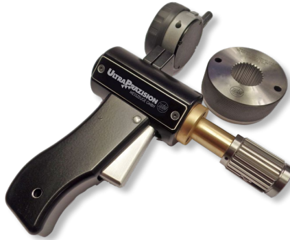
Kombo-Verzahnungslehrrörne mit Messuhr (analog oder digital) zum Prüfen der effektiven und tatsächlichen Zahnlückenbreite an Werkstücken mit Innenverzahnung. Combo spline plug gauges with dial gauge (analogue or digital) for checking effective and actual circular space width on internal splined work pieces.
